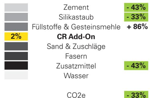
CR-Zusatzstoffe und Fertigmischungen bieten eine Vielzahl von Vorteilen. Sie reduzieren den Einsatz teurer Rohstoffe und damit den ökologischen Fußabdruck. Außerdem wird die Verarbeitbarkeit während des gesamten Produktionsprozesses erheblich verbessert, wie z. B. durch eine höhere Stabilität von Mörteln und Betonen beim Mischen und Gießen, die Verhinderung von Entmischungen, die Verringerung des Ausblutens, die Verbesserung der Pumpfähigkeit und die Erhöhung der Frühfestigkeit.
