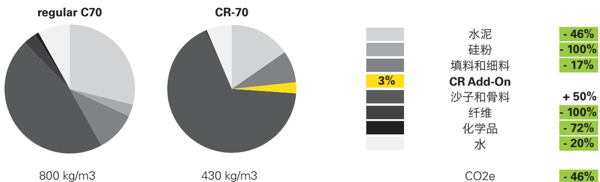
CR添加物和预拌粉提供了众多的好处。减少昂贵的原材料的使用，从而减少对生态环境的影响。在整个生产过程中，大大改善了可操作性，包括在混合和浇注过程中增强砂浆和混凝土的稳定性，防止成分分离，减少泛浆，避免离析，改善可泵性，并增加早期强度。
